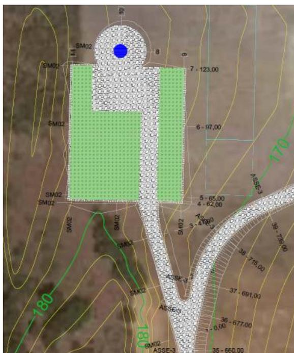
Nelle aree di installazione degli aerogeneratori è prevista la realizzazione di “piazzole” di montaggio; si tratta di aree delle dimensioni di circa 50x40 metri utili allo stoccaggio temporaneo a piè d’opera dei vari componenti degli aerogeneratori nonché per l’ubicazione della gru.
