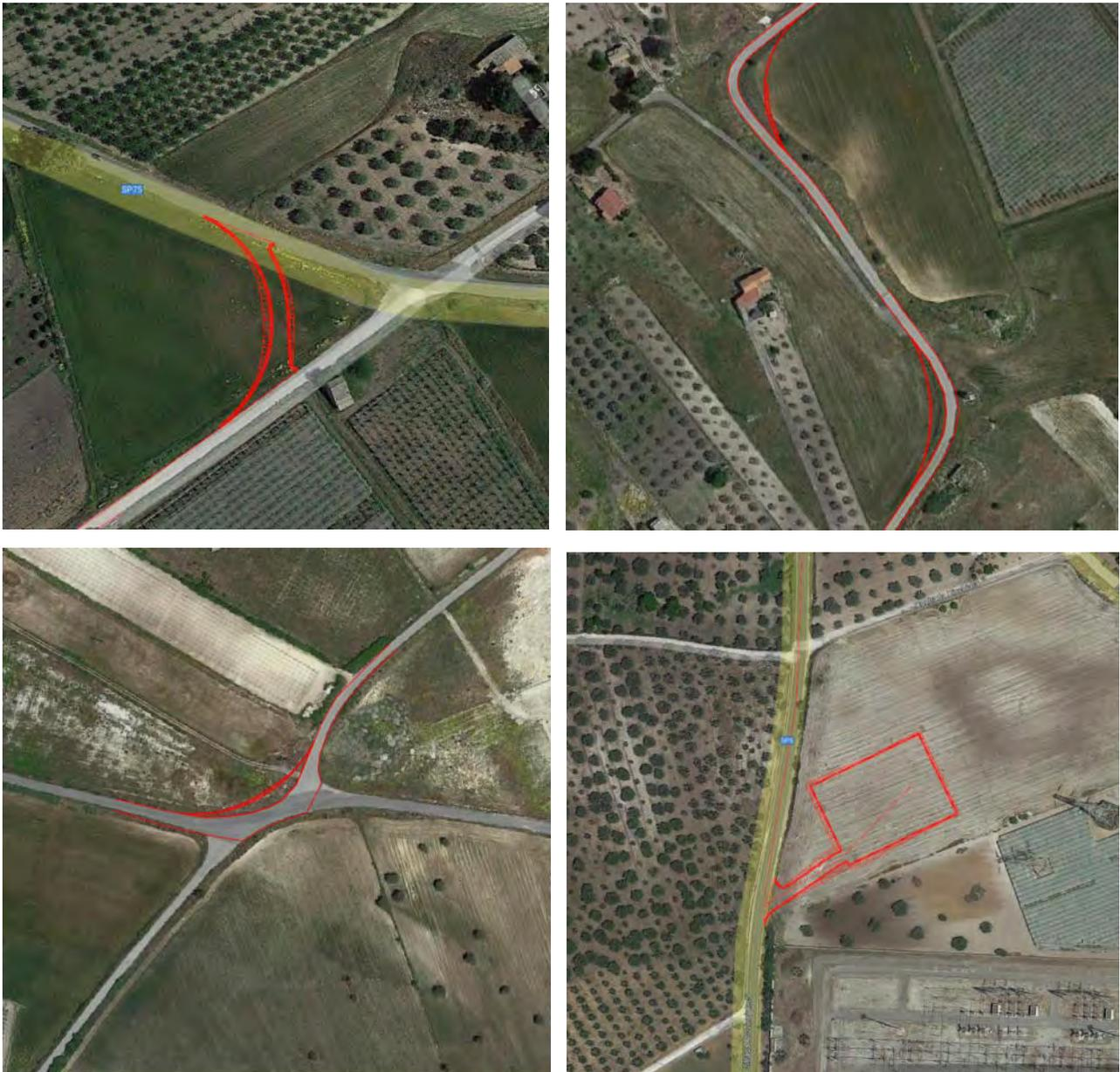
*Figura 2-101 – Adeguamento della viabilità stradale. Sopra a sinistra adeguamento alla SP75 e a destra a strada podereale presso l'innesto con la SP75; sotto a sinistra adeguamento di incrocio stradale presso Fattoria Fornazzo e contrada Sciri Donna, a destra viabilità di accesso alla centrale TERNA lungo la SP5*
