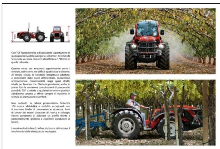
**Figura 6 – Trattore con potenza di circa 100 cavalli alto 174 cm compresa la cabina**
