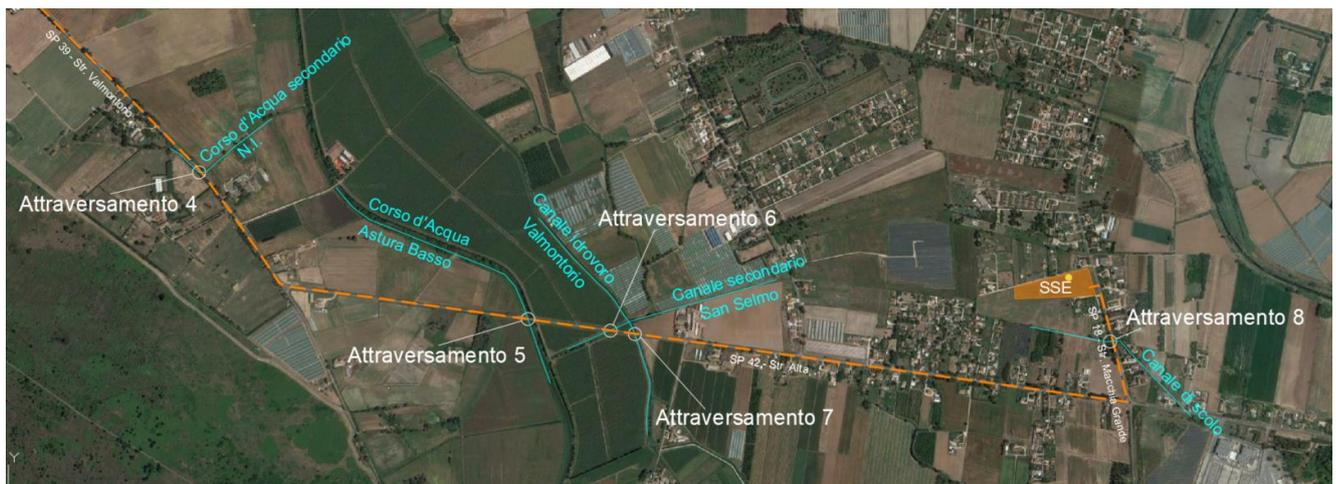
**Figura 3: Stralcio del cavidotto in MT e delle interferenze attraversate**
