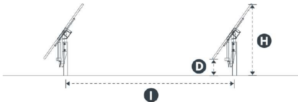
Figura 7: Vista laterale della struttura portamoduli tracker
