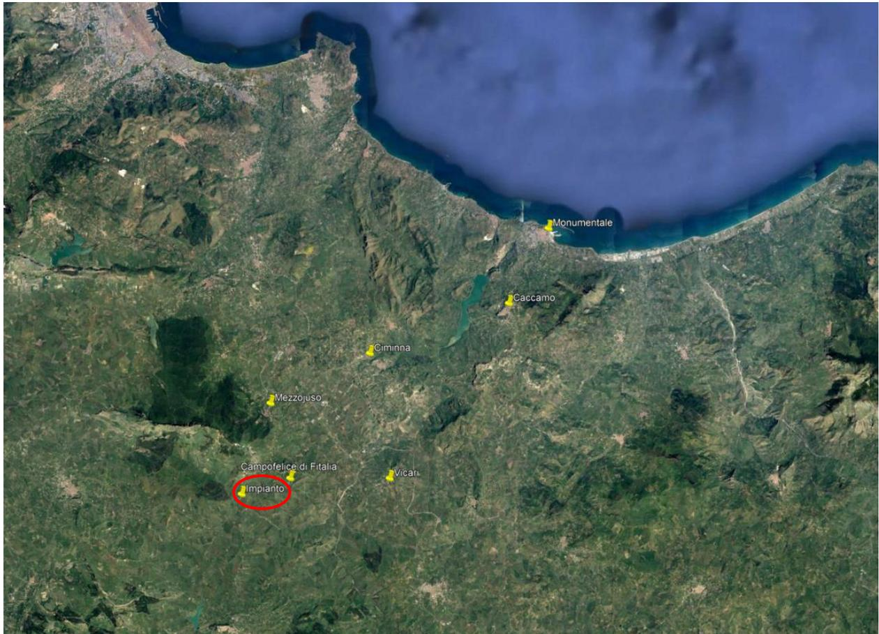
Figura 7: Ubicazione delle stazioni pluviometriche con indicazione dell’impianto
