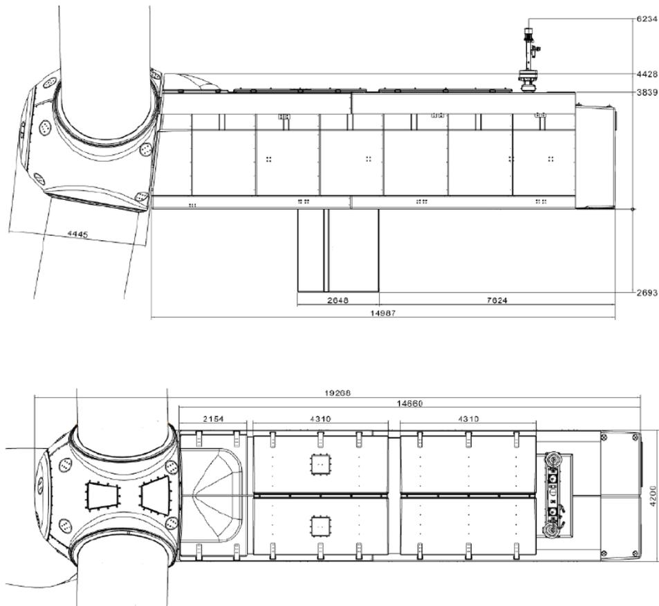
L'ogiva è grande a sufficienza per consentire di accedere direttamente, dalla navicella, ai sistemi di controllo del passo, situati all'interno del mozzo, per eseguire la manutenzione. Per l'assorbimento acustico l'intera navicella è rivestita di materiale fonoassorbente.
