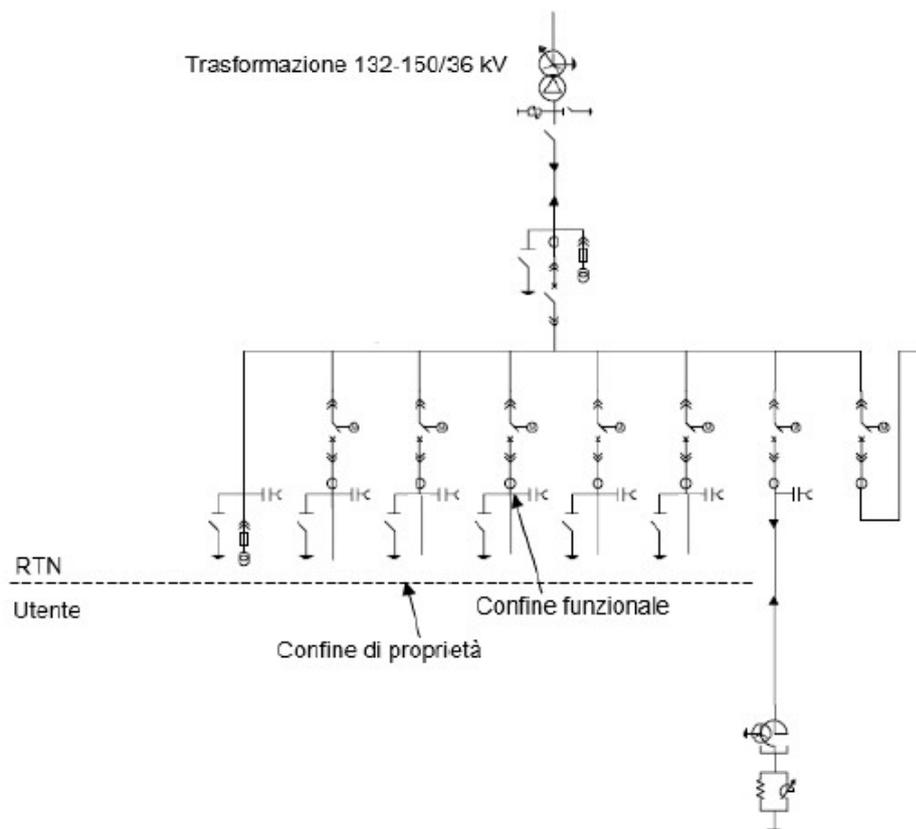
**Figura 4 - Schema di connessione esemplificativo a 36 kV**
