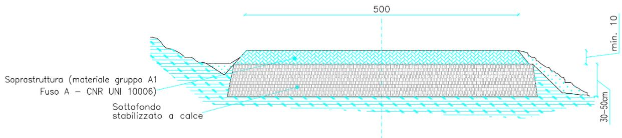
**Figura 1- Sezione tipo stradale**
