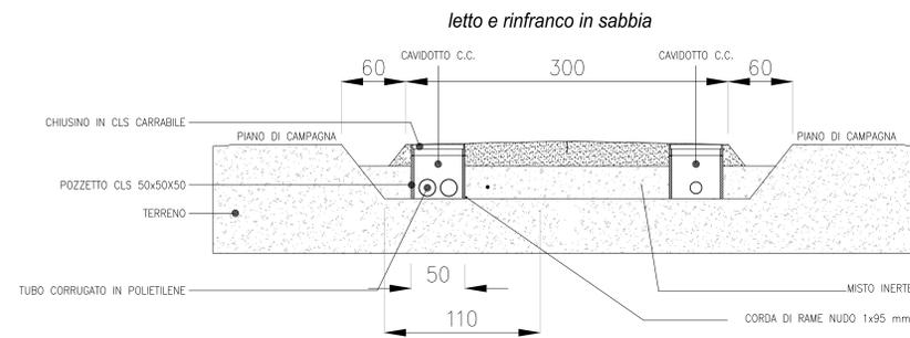
POZZETTO TIPO CAVIDOTTI C.C. *scala 1:10*
