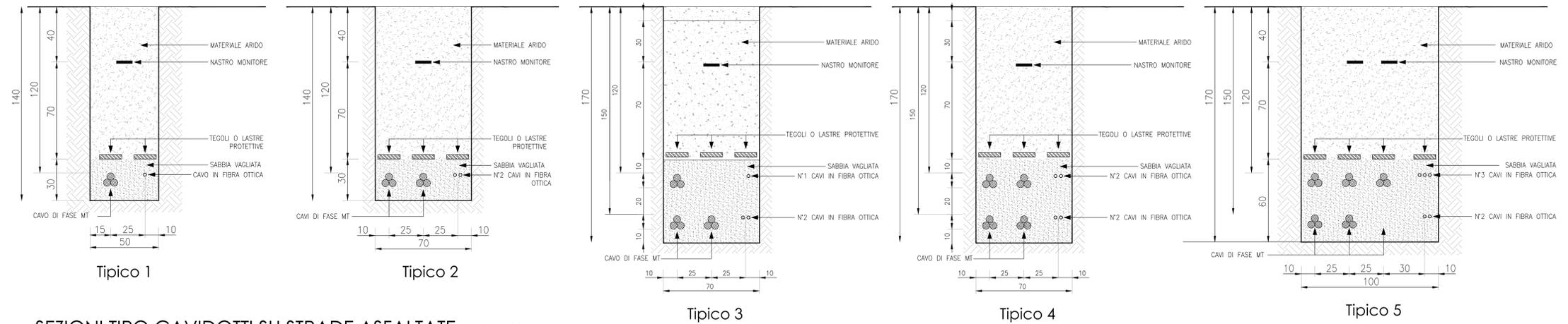
SEZIONI TIPO CAVIDOTTI SU STRADE ASFALTATE *scala 1:10*
