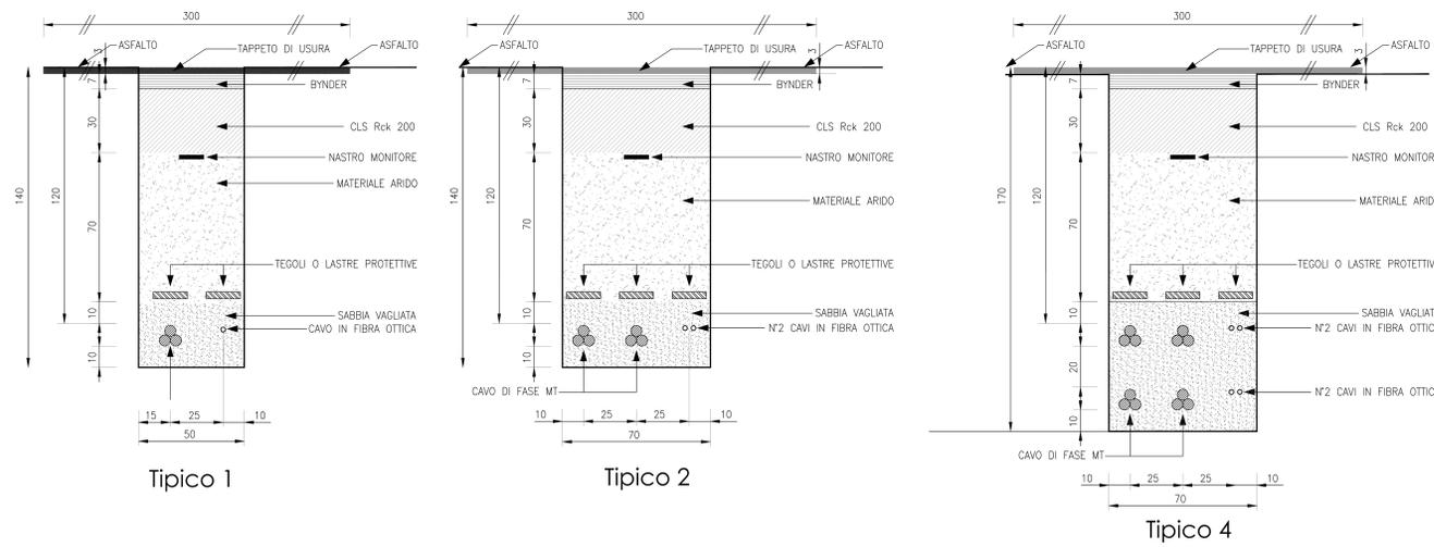
SEZIONI TIPO CAVIDOTTI C.C. *scala 1:20*
