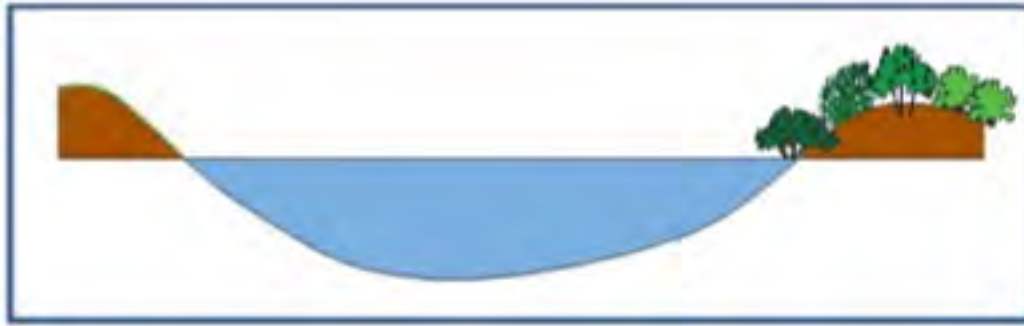
Figura 156 - Inerbimento sponde con miscela per idrosemina e piantumazione di arbusti
