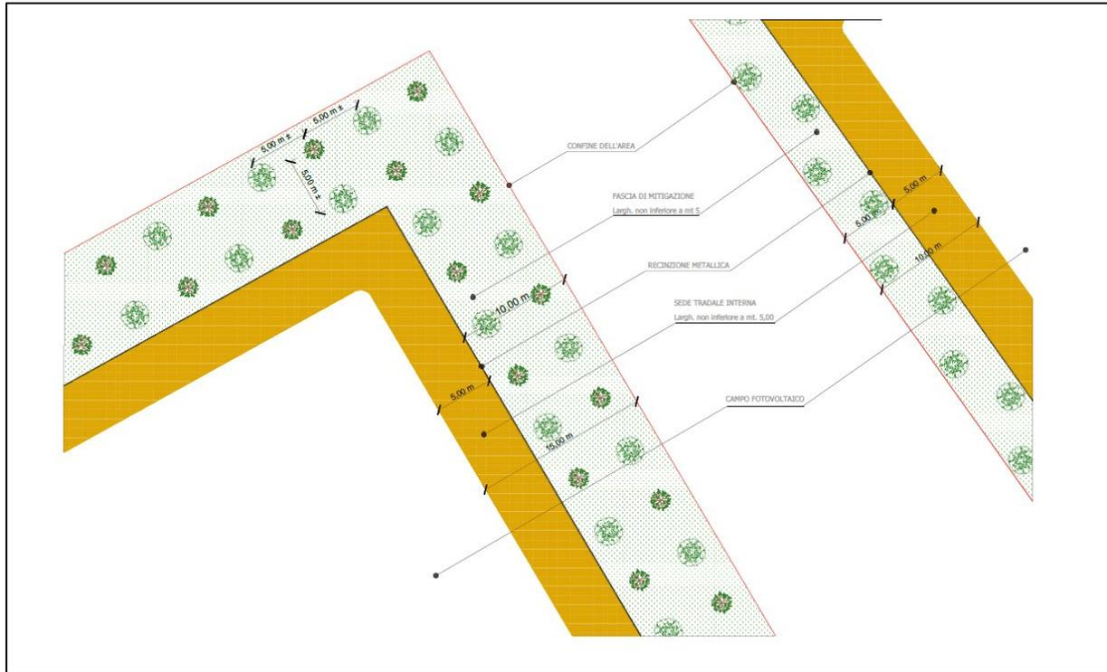
Figura 23 Layout fascia di mitigazione perimetrale- Pianta
