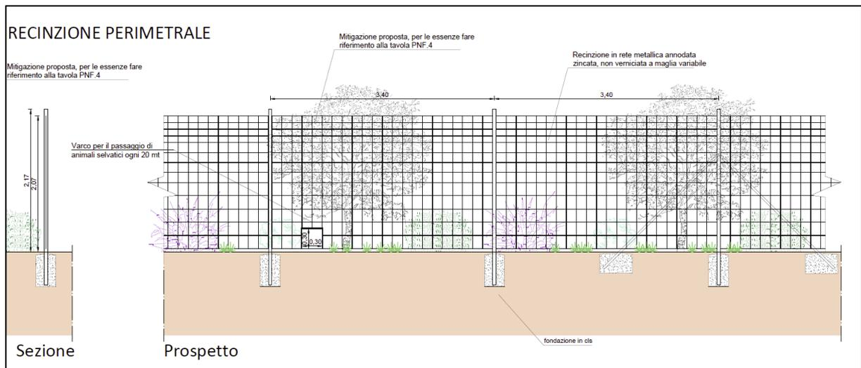
Figura 21 Dettaglio della Recinzione Perimetrale
