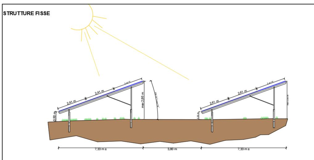
Figura 16 Prospetto laterale frame's layout
