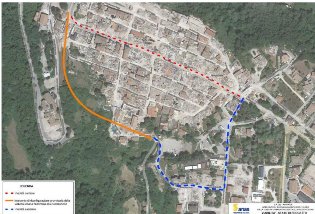
Figura 45 Riconfigurazione provvisoria della viabilità di servizio funzionale alle attività di ricostruzione del centro storico
