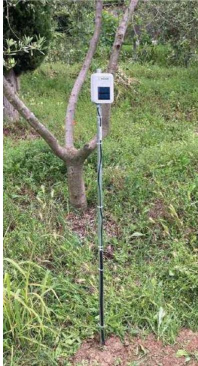
Figura 9 – Esempio di sensore di rilievo dato temperatura e umidità del suolo (parte infissa nel terreno).
