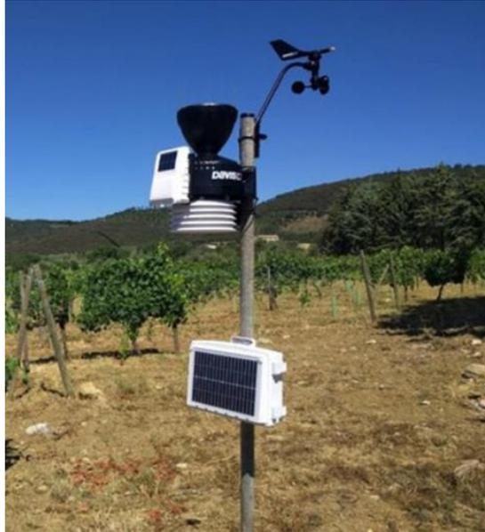
*Figura 7 - Esempio di stazione meteo completa alimentata da energiasolare.*
