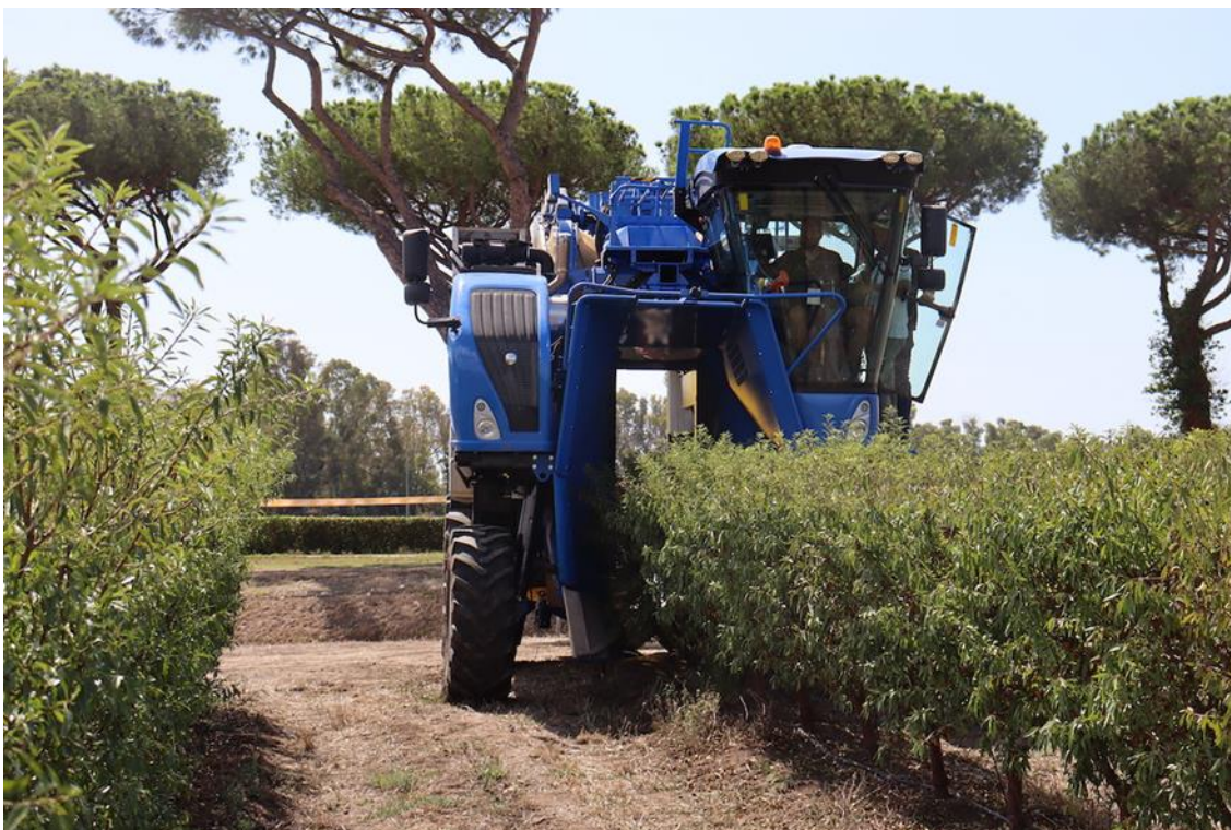
Figura 23 – Macchina scavallatrice durante le operazioni di raccolta in mandarletto superintensivo a siepone.
