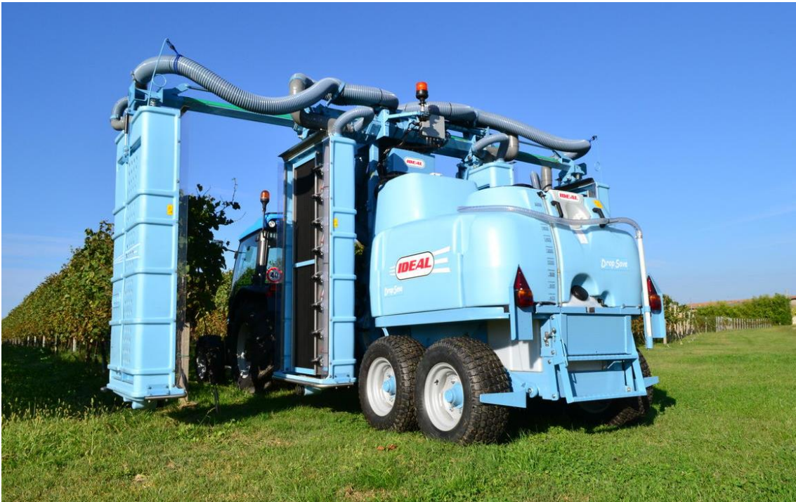
Figura 21 – Pompa irroratrice a polverizzazione pneumatica con diffusore anti-deriva.
