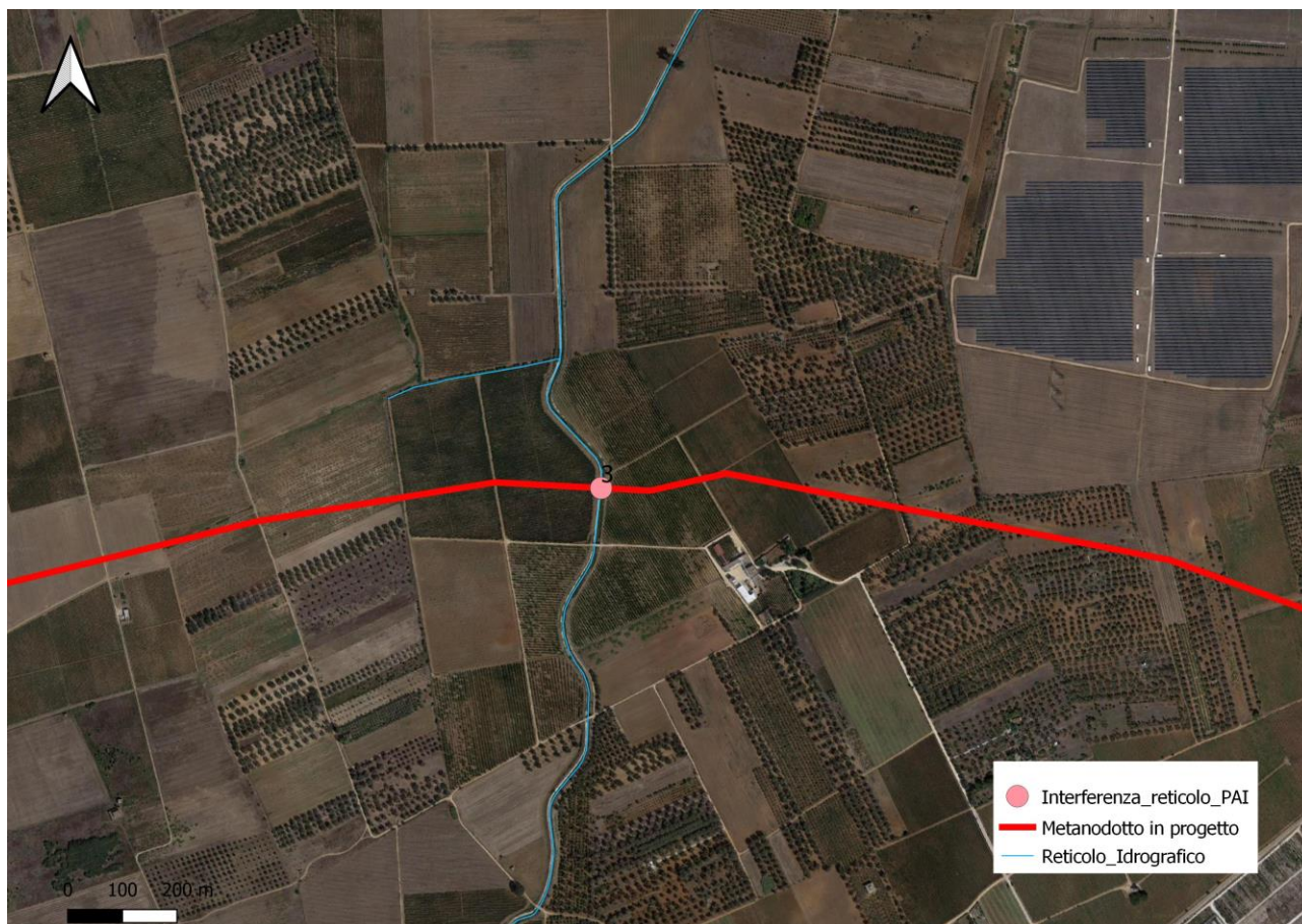
Fig. 1-2: Tracciato del metanodotto in progetto e punto di interferenza con reticolo idrografico (attraversamento 3: Canale Galina)
