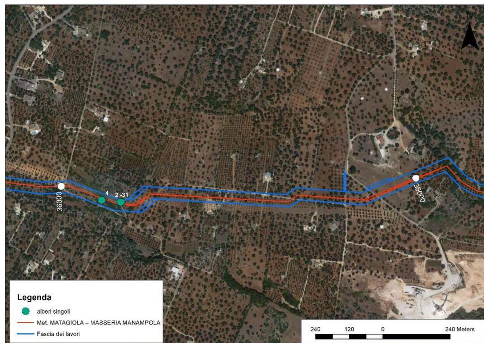
**Figura 7.2 – Localizzazione del gruppo di piante GP01 (in rosso il metanodotto in progetto, in blu la delimitazione della fascia lavori e gli eventuali allargamenti previsti in specifici tratti)**
