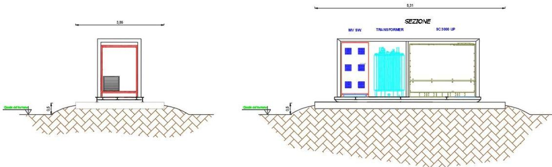
Scavo di sbancamento per posizionamento Skid Inverter di Trasformazione: 8,30 ml x 3,80 ml x 0,30 h. I metri cubi di scavo equivalgono a 9,46 m<sup>3</sup>. All'interno dei campi sono ubicate 9 cabine, per un totale di 85,14 m<sup>3</sup>.
