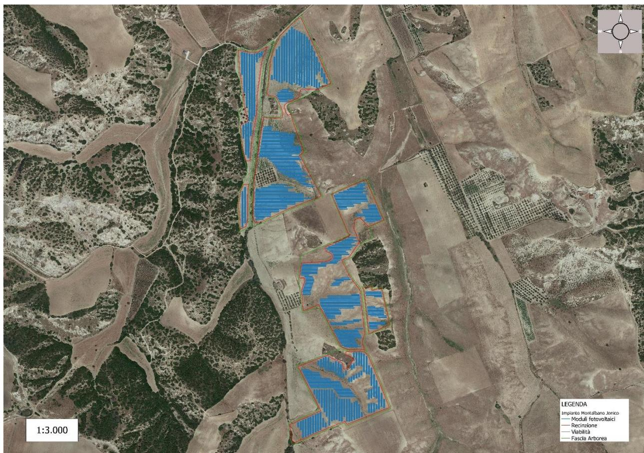
Figura 4 – Area di progetto con indicazione degli interventi agronomici e posizionamento dei moduli fotovoltaici
