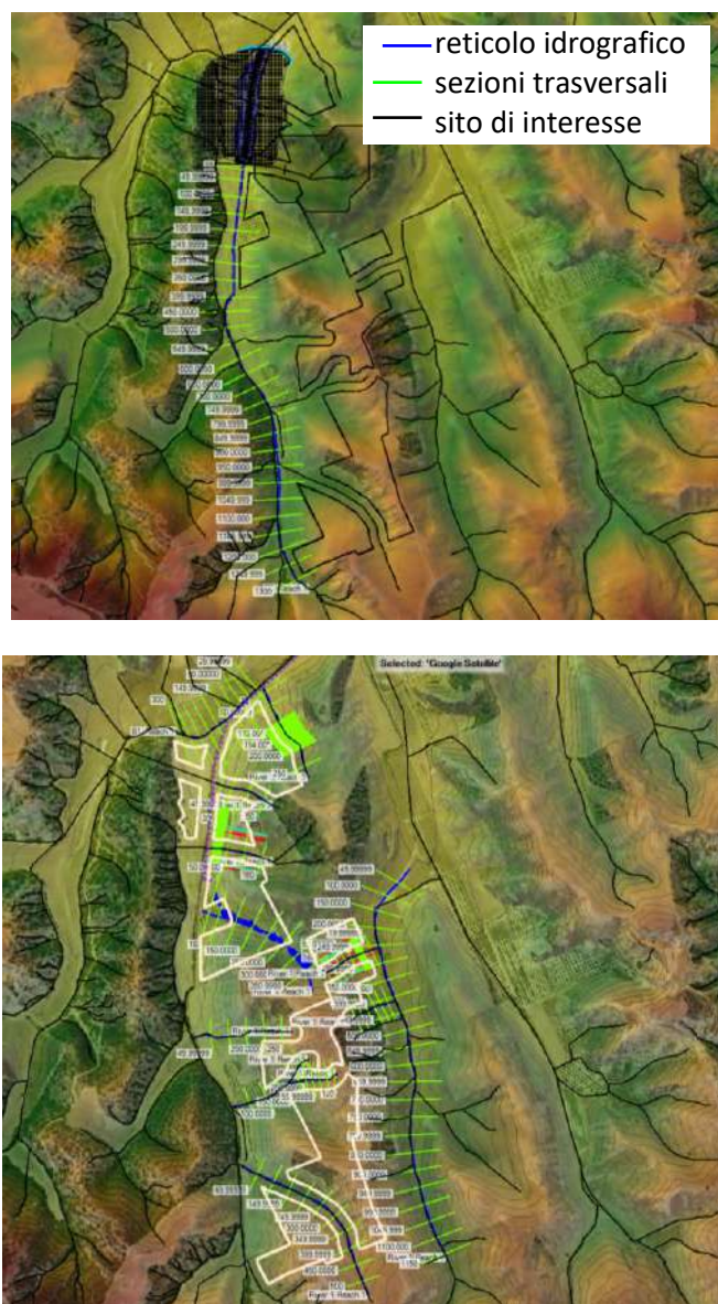
Figura 4. Schematizzazione del reticolo idrografico in ambiente HEC-RAS.
