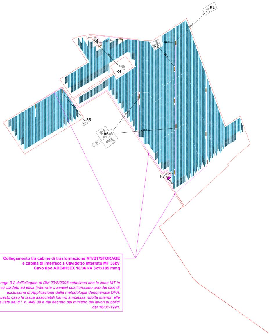
Collegamento tra cabine di trasformazione MT/BT/STORAGE e cabina di interfaccia Cavidotto interrato MT 36kV
