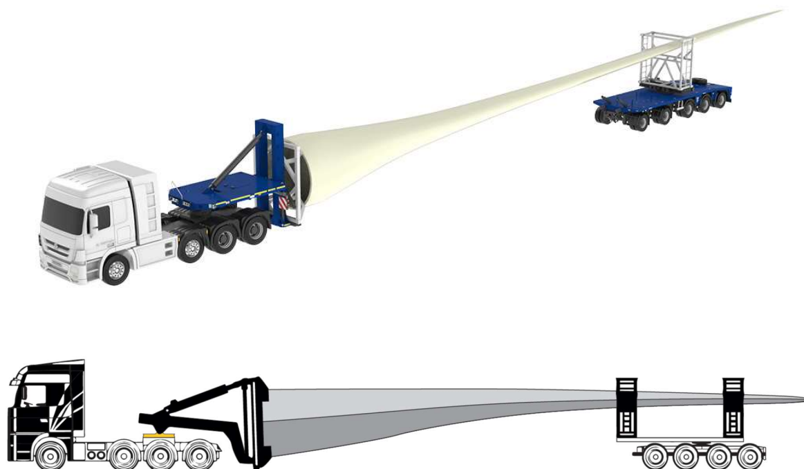
Figura 19 – Esempio di trasporto pale tipologia RBTS
