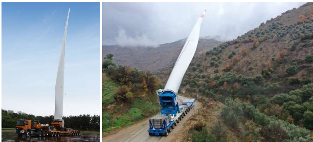
Figura 20 – Esempio di trasporto con Blade Lifter Trailer
