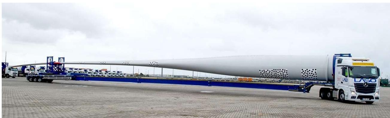
Figura 1 Esempio di trasporto pale con tipologia SWC
