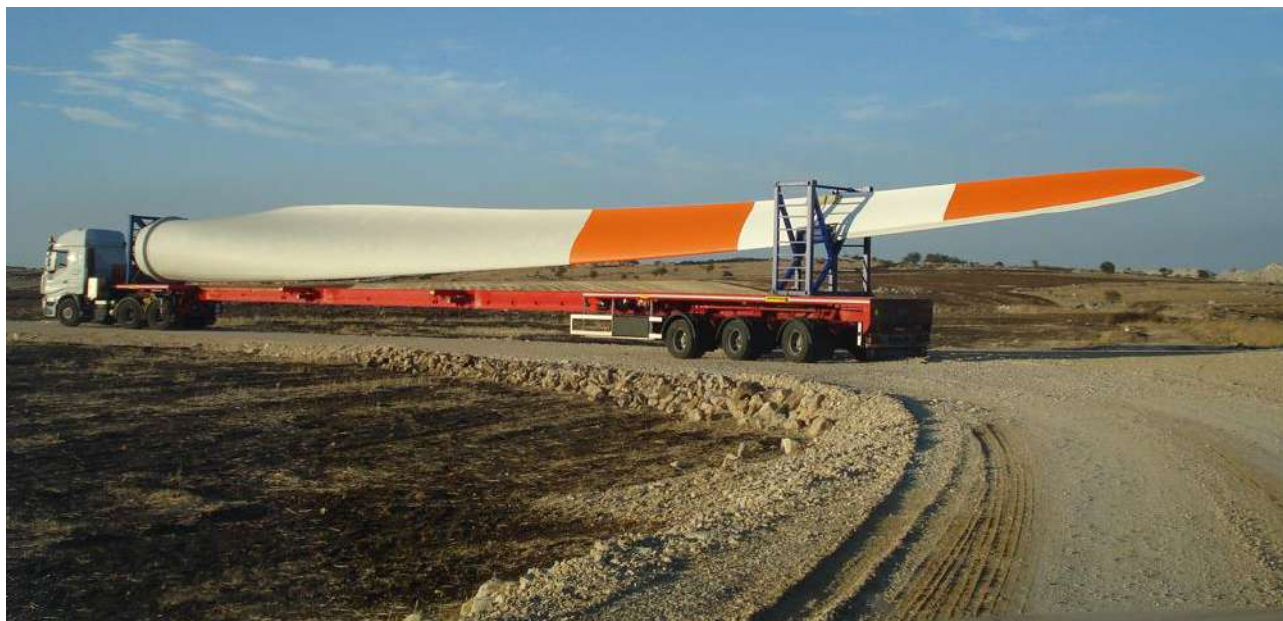
Figure 97 - Soluzione tipo del trasporto delle pale e adeguamento in curva tipo sulla viabilità esistente
