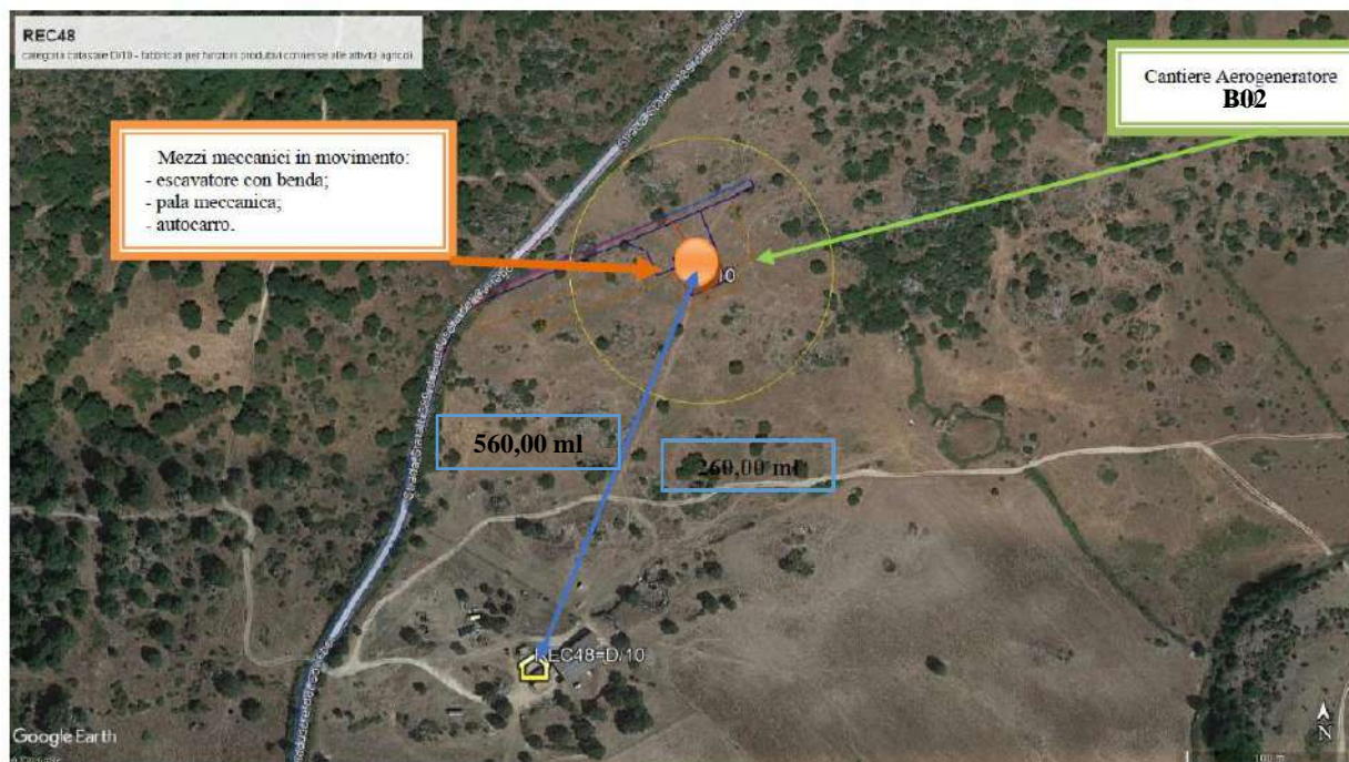
Figura 139 - Scenario 2 fondazioni Aerogeneratore B02
