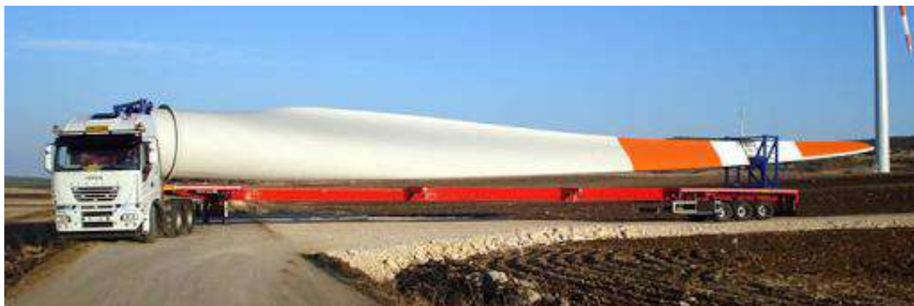
Figure 98 - Soluzione tipo del trasporto delle pale e pista di nuova realizzazione tipo per l'accesso alla turbina
