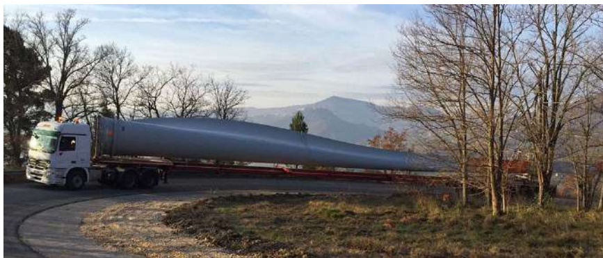
Figure 92 - Soluzione tipo del trasporto della pala e adeguamento in curva tipo sulla viabilità esistente
