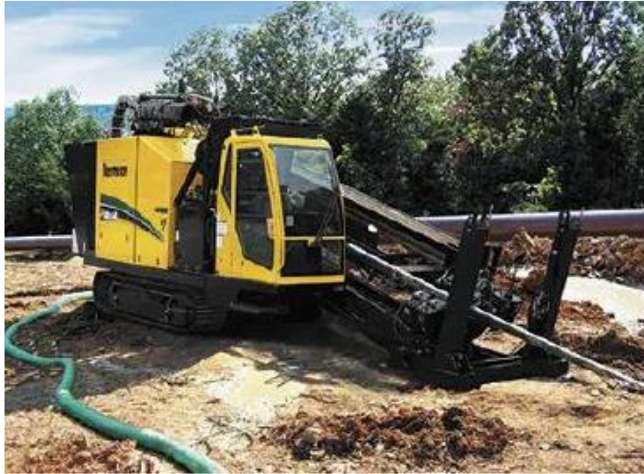
Figura 11. Esempio macchina perforatrice per TOC
