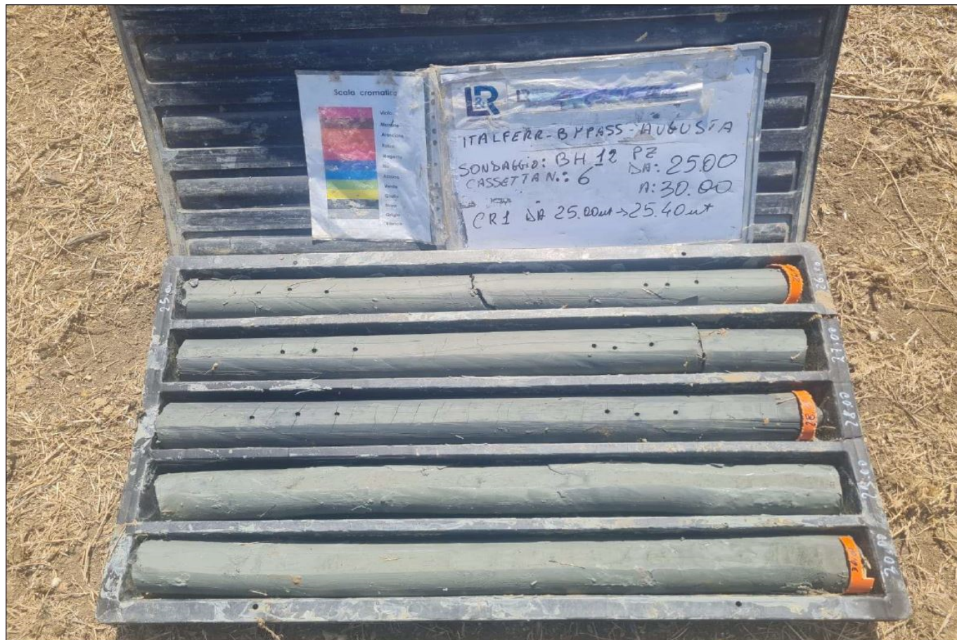
Figura 10 – Terreni prevalentemente pelitici del Sintema Lentini (LEI2) nel foro di sondaggio BH12_PZ, tra 25.0 m ed 30.0 m di profondità dal p.c..
