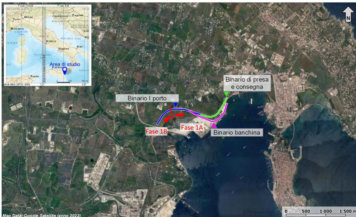
**Figura 1 – Corografia in scala 1:50000 dell’area di studio geologico con individuazione delle opere in progetto (binario I porto in blu, binario banchina in magenta e binario di presa e consegna in verde).**
