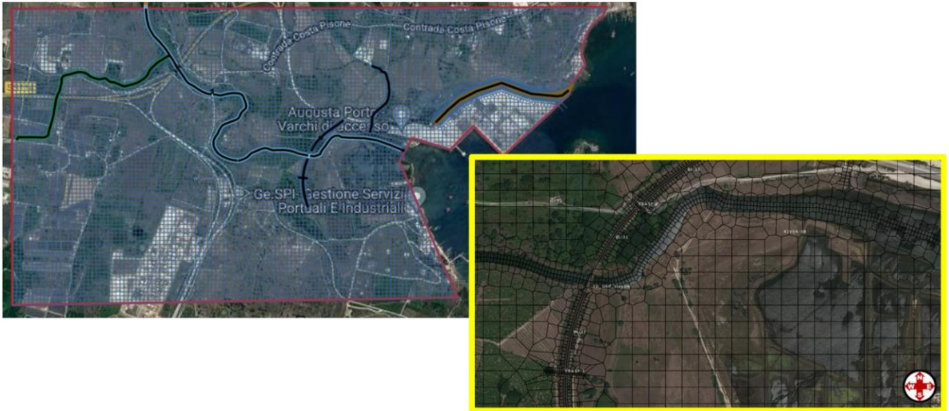
Figura 16 Refinement mesh di calcolo tramite inserimento di Breaklines (BL)
