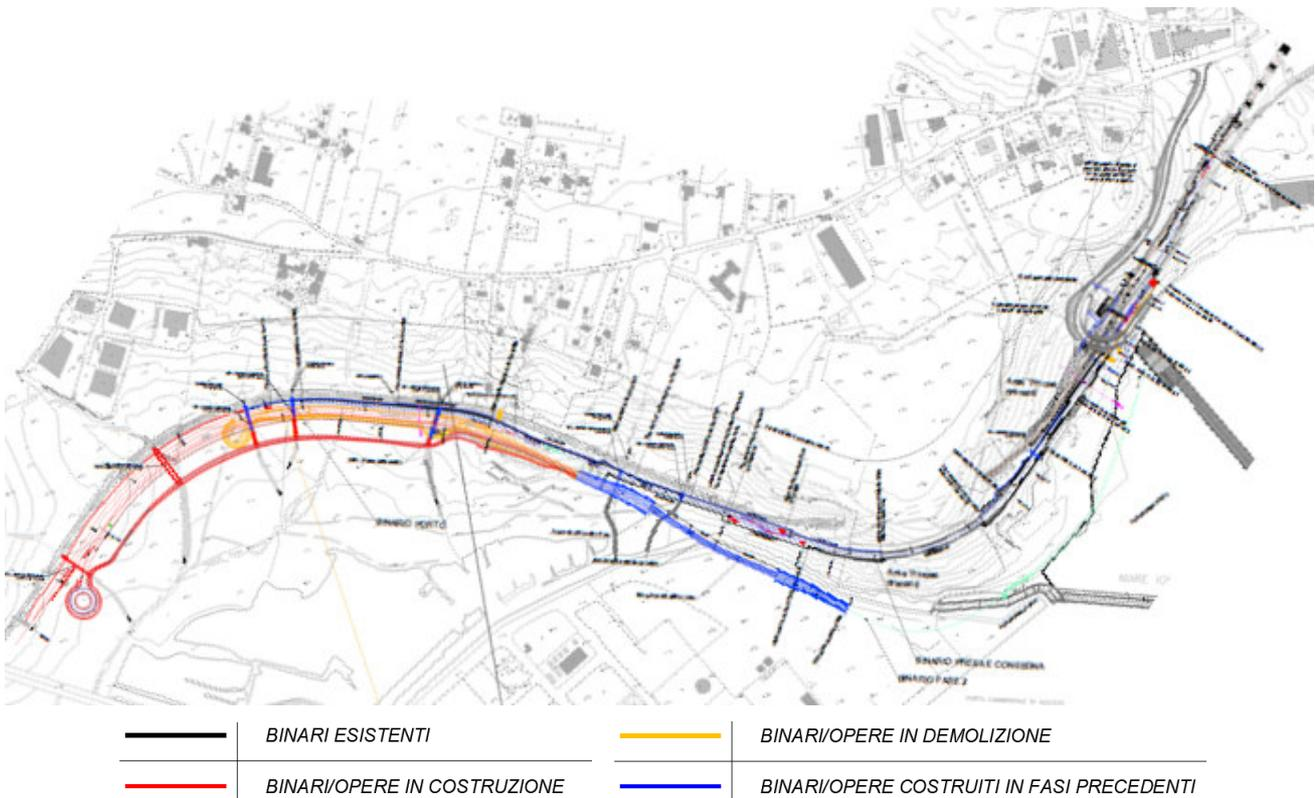
*Figura 4-2 Collegamento ferroviario con il Porto di Augusta - Assetto finale*
