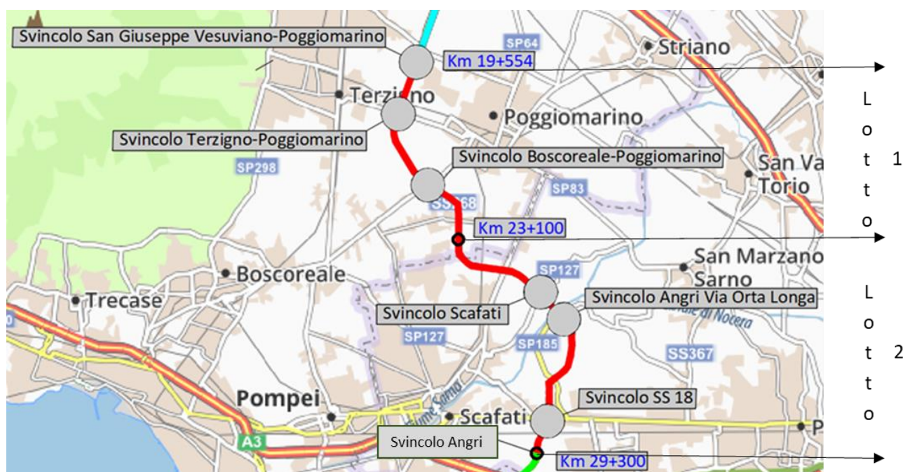
Figura 4-9: Individuazione asse stradale e svincoli
