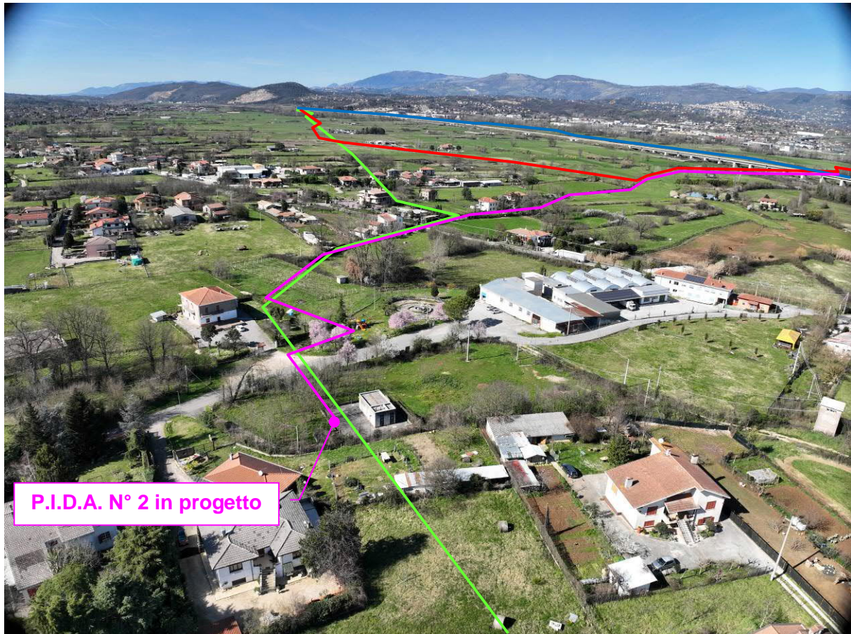
Foto 66: Metanodotto da dismettere nel Comune di Supino e Rifacimento Allaccio Comune di Supino
