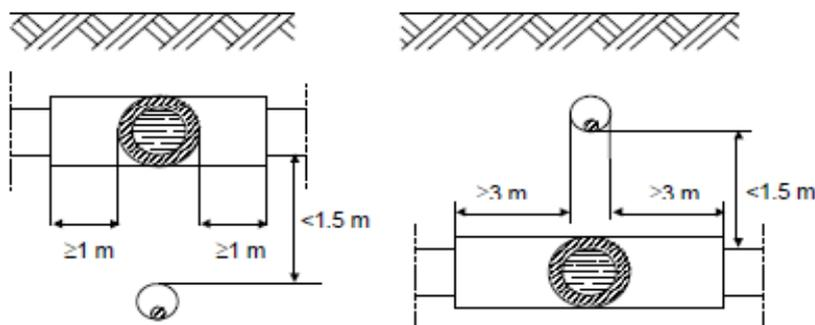
Nei parallelismi tra canalizzazioni per cavi elettrici e tubazioni non drenate, la distanza minima tra le due superfici affacciate non deve essere inferiore alla profondità di interramento della condotta del gas, salvo l'impiego di diaframmi continui di separazione (vedasi figure seguenti)
