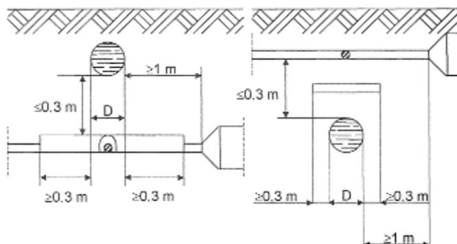
I manufatti di protezione e gli elementi separatori in calcestruzzo armato sono da considerarsi strutture non metalliche. Come manufatto di protezione di singole strutture con sezione circolare possono essere utilizzati collari di materiale isolante fissati ad esse.
