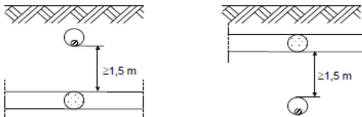
Qualora non sia possibile osservare tale distanza, la tubazione del gas deve essere collocata entro un tubo di protezione che deve essere prolungato da una parte e dall'altra dell'incrocio per almeno 1 m nei sottopassi e 3 m nei sovrappassi; le distanze vanno misurate a partire dalle tangenti verticali alle pareti esterne della canalizzazione; in ogni caso deve essere evitato il contatto metallico tra le superfici affacciate (vedasi figure seguenti).
