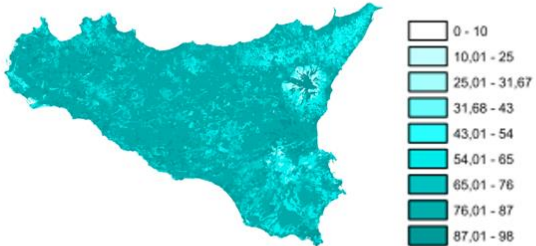
Figura 8: Stralcio della Tav.7 allegata alla Relazione Generale del P.A.I, con griglia areale del coefficiente “CN”
