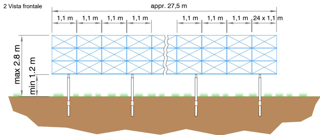
La profondità di interrimento dei pali di fondazioni varia in funzione della forma e delle condizioni di carico locali, e delle condizioni geologiche del sito
