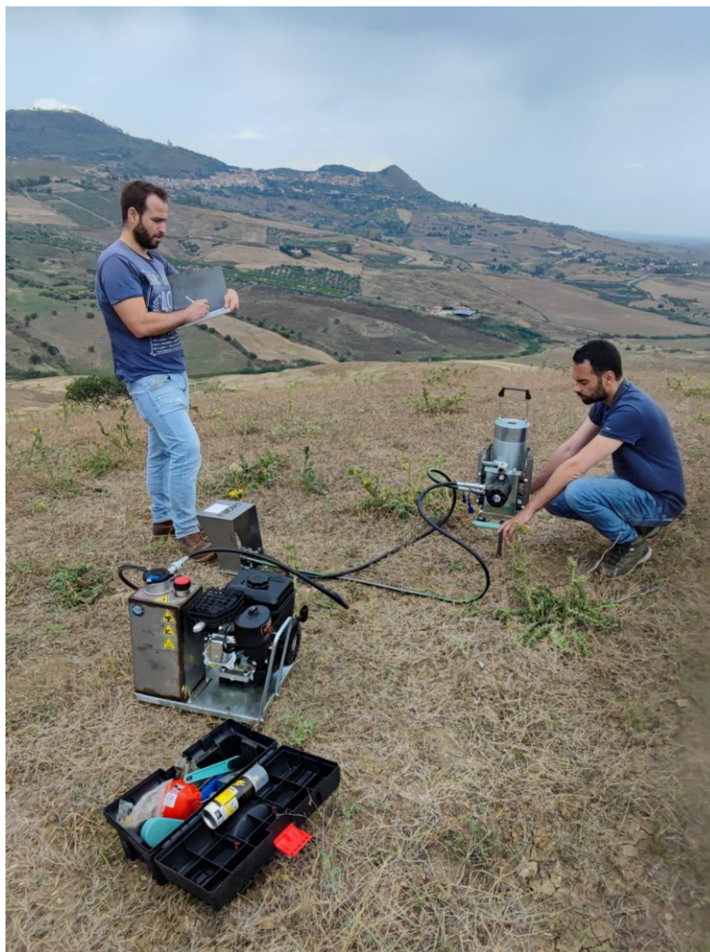
Figura 3 – Fase di acquisizione della prova penetrometrica DP2.
