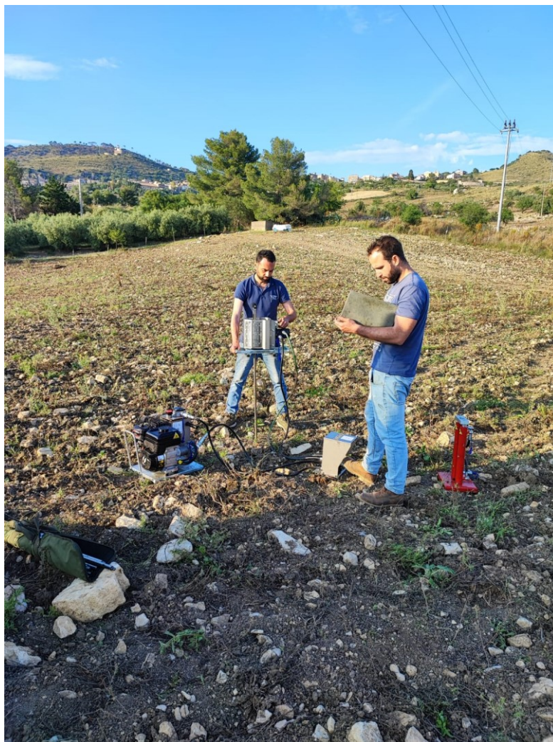
Figura 4 – Fase di esecuzione della prova penetrometrica DP3.
