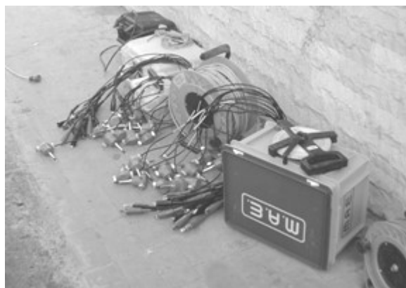
Figura 13 – Geofoni verticali – freq. 4.5 hz
