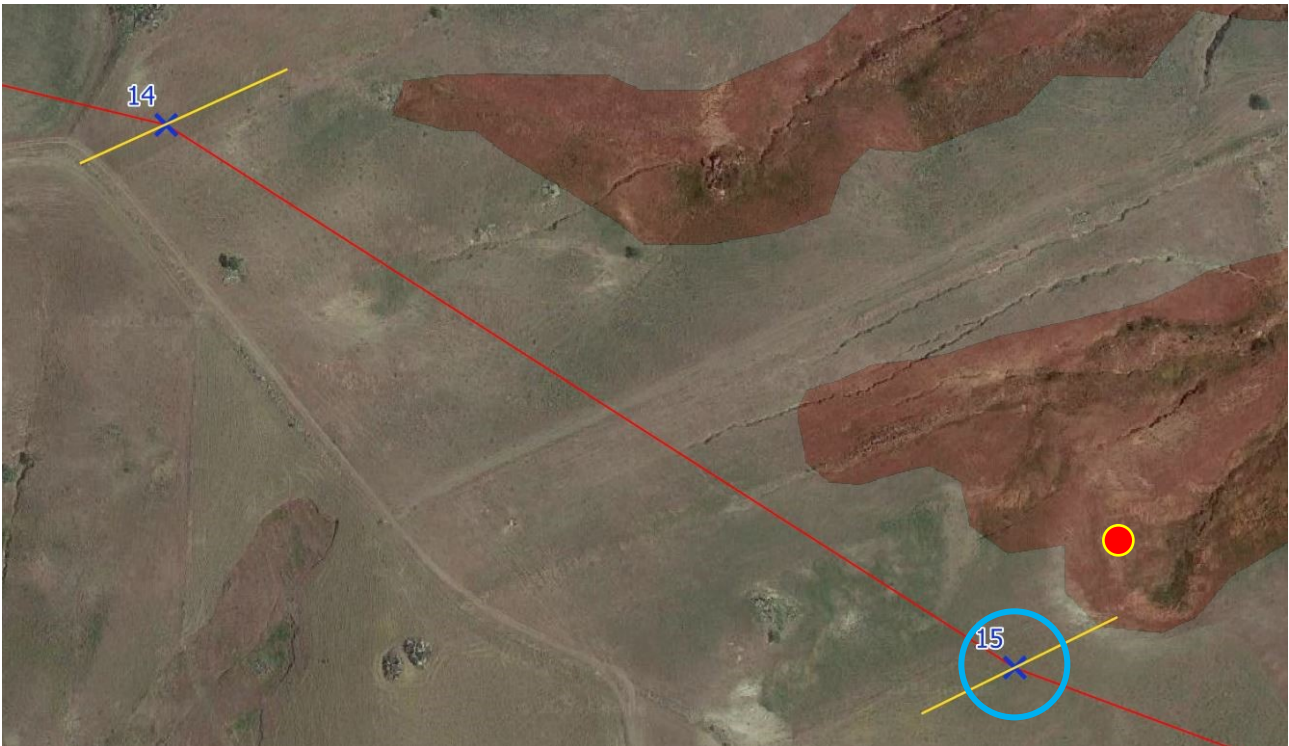
Figura 4 – Ubicazione di progetto del traliccio n. 15. In giallo la traccia di sezione per la verifica di stabilità. In rosso sono evidenziate le aree a pericolosità geomorfologica P2. Il punto rosso indica la posizione della foto riportata di seguito.
