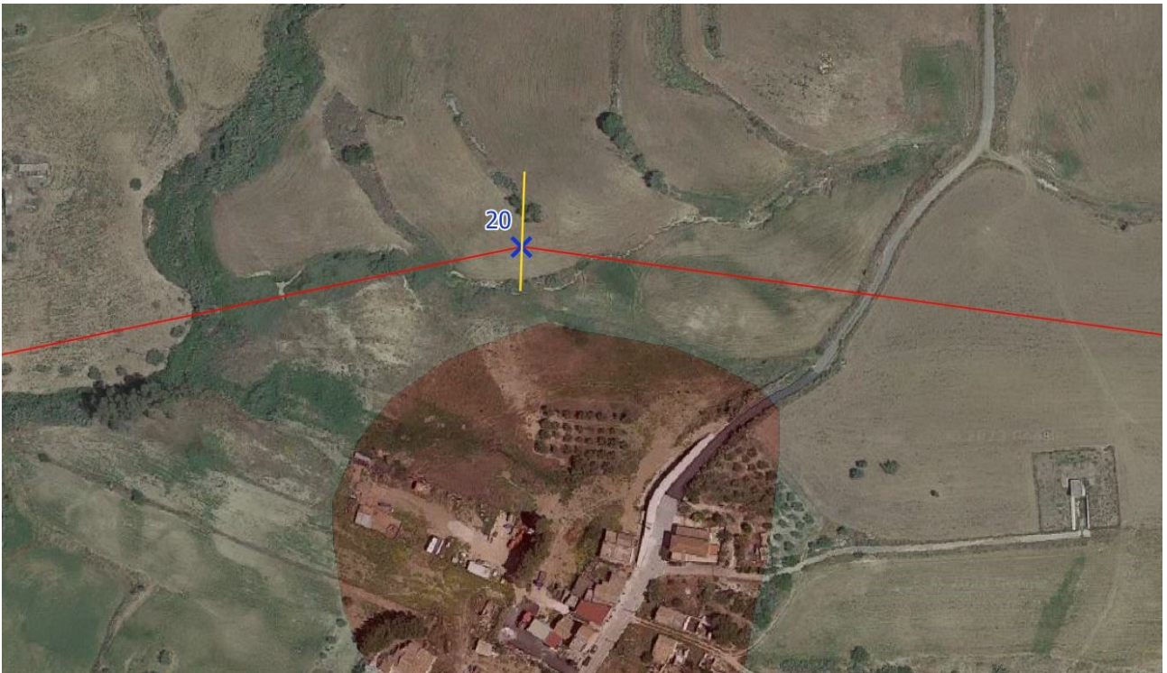
Figura 8 – Ubicazione di progetto del traliccio n. 15. In giallo la traccia di sezione per la verifica di stabilità. In rosso sono evidenziate le aree a pericolosità geomorfologica P3-P4
