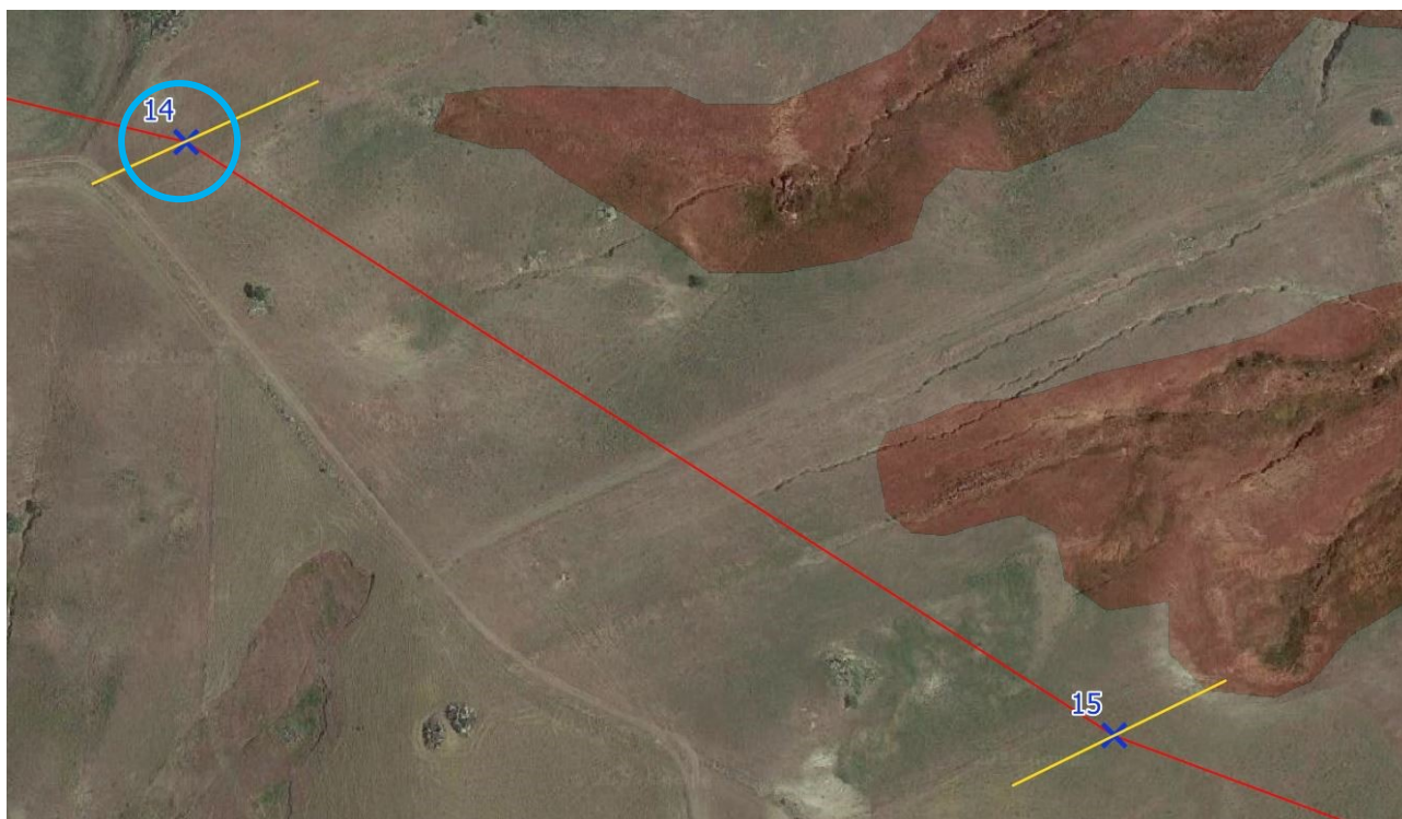
Figura 1 – Ubicazione di progetto del traliccio n. 14. In giallo la traccia di sezione per la verifica di stabilità. In rosso sono evidenziate le aree a pericolosità geomorfologica P2
