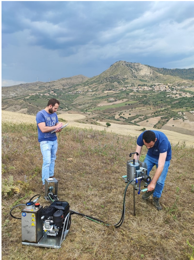
Figura 2 – Fase di esecuzione della prova penetrometrica DPI.
