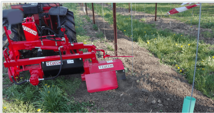
Figura 8.1 esempio di macchina operatrice con fresa interfilare per la pulizia dell'area al di sotto dei pannelli
