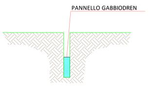
**FASE 3 - RINTERRO DELLO SCAVO CON MATERIALE DI RISULTA DELLO SCAVO STESSO**
