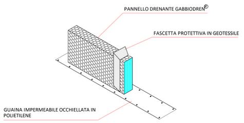
**FASE 3 - RISVOLTO DELLE FASCETTE PROTETTIVE IN GEOTESSILE E ANCORAGGIO DELLA GUAINA IMPERMEABILE OCCHIELLATA ALLA BASE DEI PANNELLI DRENANTI**
