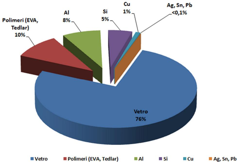
Figura 4.3 – Composizione di un modulo FV in c-Si
