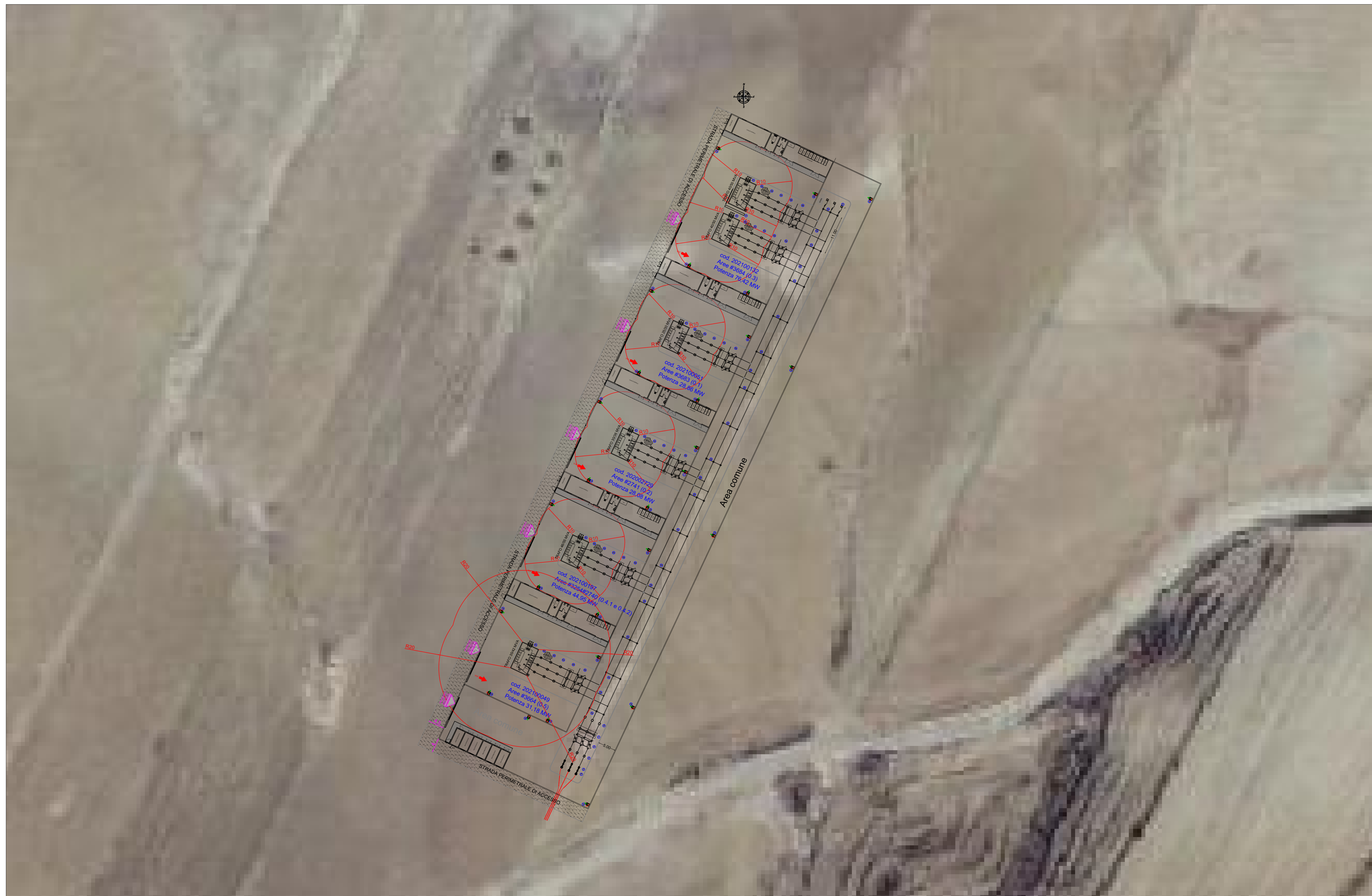
Planimetria sottostazione distanze di sicurezza esterne - Scala 1:500
