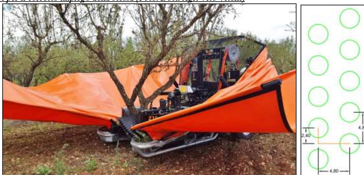
Figura 7.1: Macchina frontale per la raccolta delle mandorle su impianto intensivo e disposizione ideale degli alberi per il corretto impiego della stessa (Foto: Dott. Agr. Vito Vitelli)
