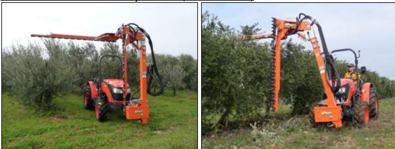
Figura 8.3: Esempio di potatrice meccanica frontale a doppia barra (taglio verticale + topping) utilizzabile su tutti le colture arboree intensive e superintensive (Foto: Rinieri S.r.l.)
