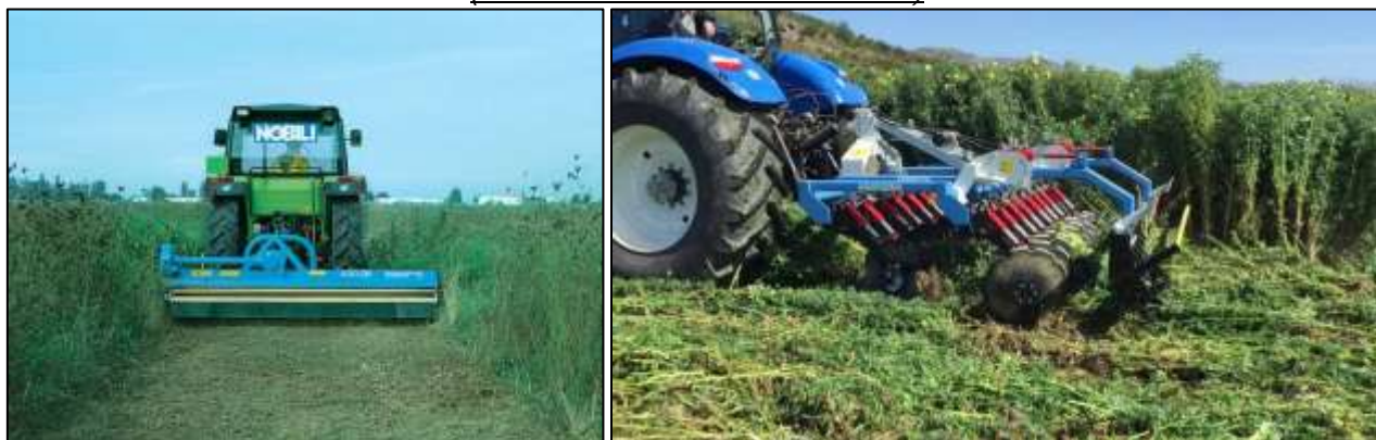
Fig. 6.8: Trinciatura del manto erboso, utilizzando la trincia o direttamente con il frangizolle a dischi (Foto: Nobili S.r.l. / Siciltiller S.r.l.)
