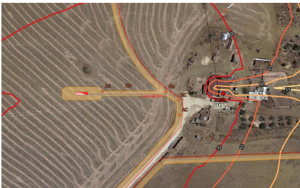
Figura 9 Calcolo delle isofone nella fase di posa delle cabine ipotizzando il contemporaneo impiego di autogrù (AG) e camion rimorchio (CM) nelle posizioni più critiche rispetto al recettore R138
