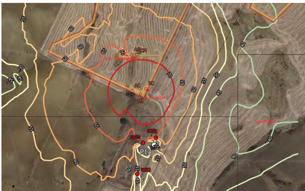
Figura 7 Calcolo delle isofone nella fase di realizzazione della viabilità interna ipotizzando il contemporaneo impiego di autocarro (AC), pala meccanica (PM), rullo compattatore (RC) nelle posizioni più critiche rispetto al recettore R200
