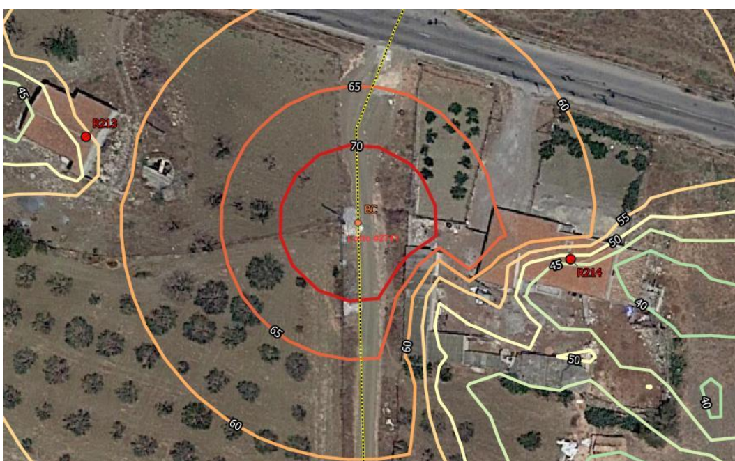
Figura 13 Calcolo delle isofone nella fase di posa del cavidotto AT ipotizzando l'impiego di escavatore bobcat (BC) nelle posizioni più critiche rispetto al recettore R214
