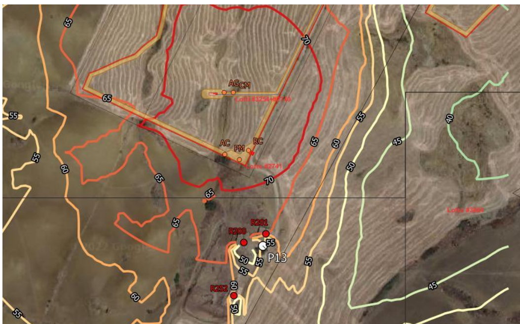
Figura 11 Calcolo delle isofone nella fase di posa delle cabine ipotizzando il contemporaneo impiego di autogrù (AG) e camion rimorchio (CM) nelle posizioni più critiche rispetto al recettore R200
