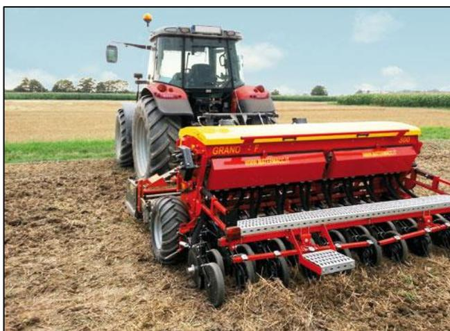
Figura 29: Esempio di seminatrice di precisione per tutte le tipologie di sementi
