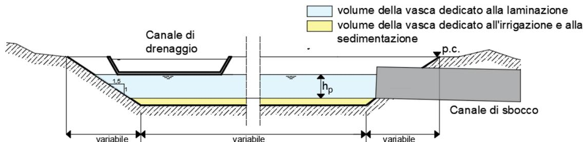
Figura 43 Sezione tipo della vasca di laminazione
