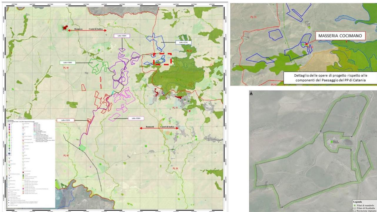
Figura 94 Particolare dell'inquadramento dell'area di progetto rispetto al Bene Isolato "Masseria Cocimano". In basso a destra dettaglio delle opere di mitigazione previste al fine di un migliore inserimento paesaggistico.
