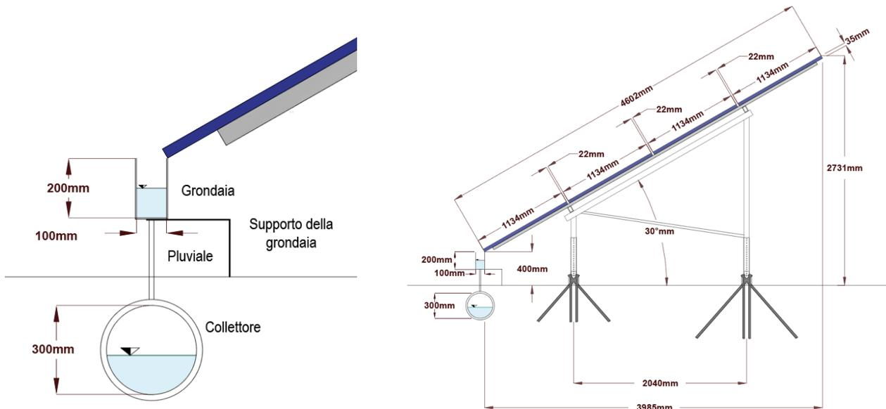
Figura 42: Dettaglio dello schema del sistema di raccolta delle acque zenitali
