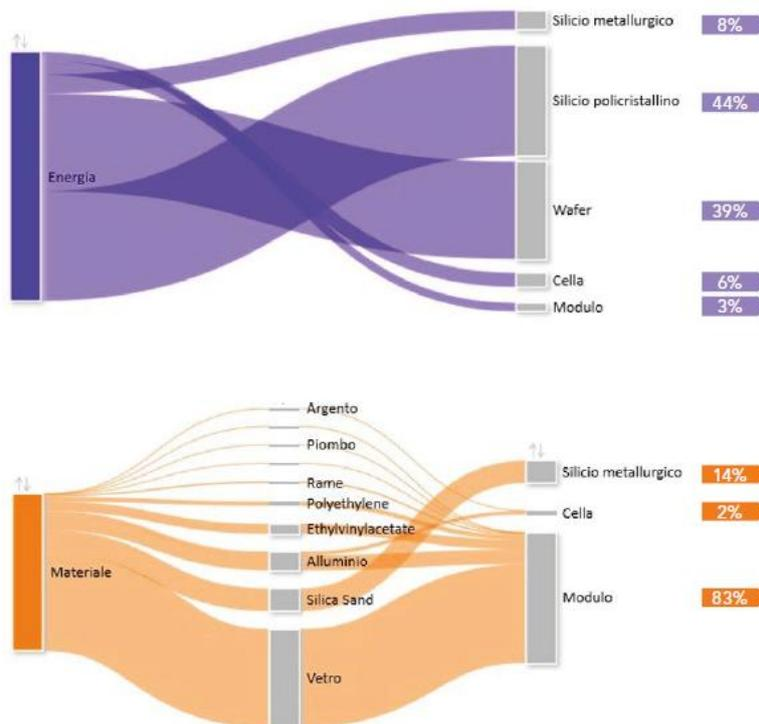
Figura 25: Fotovoltaico – BoL - Produzione e assemblaggio: consumo di energia e di materiali
