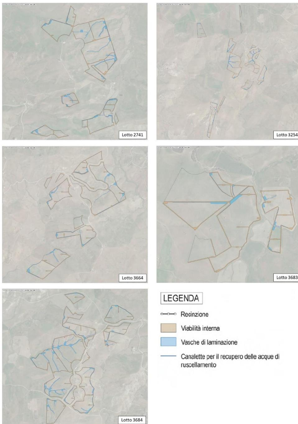
**Figura 41: Vasche di raccolta delle acque zenitali. Quadro d'insieme delle vasche di laminazione previste dal progetto. Per l'analisi puntuale si rimanda alle tavole di dettaglio allegate al progetto.**
