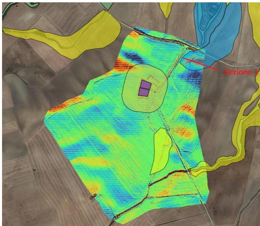
***Rilievo altimetrico, zone PAI e sezione verificata***
