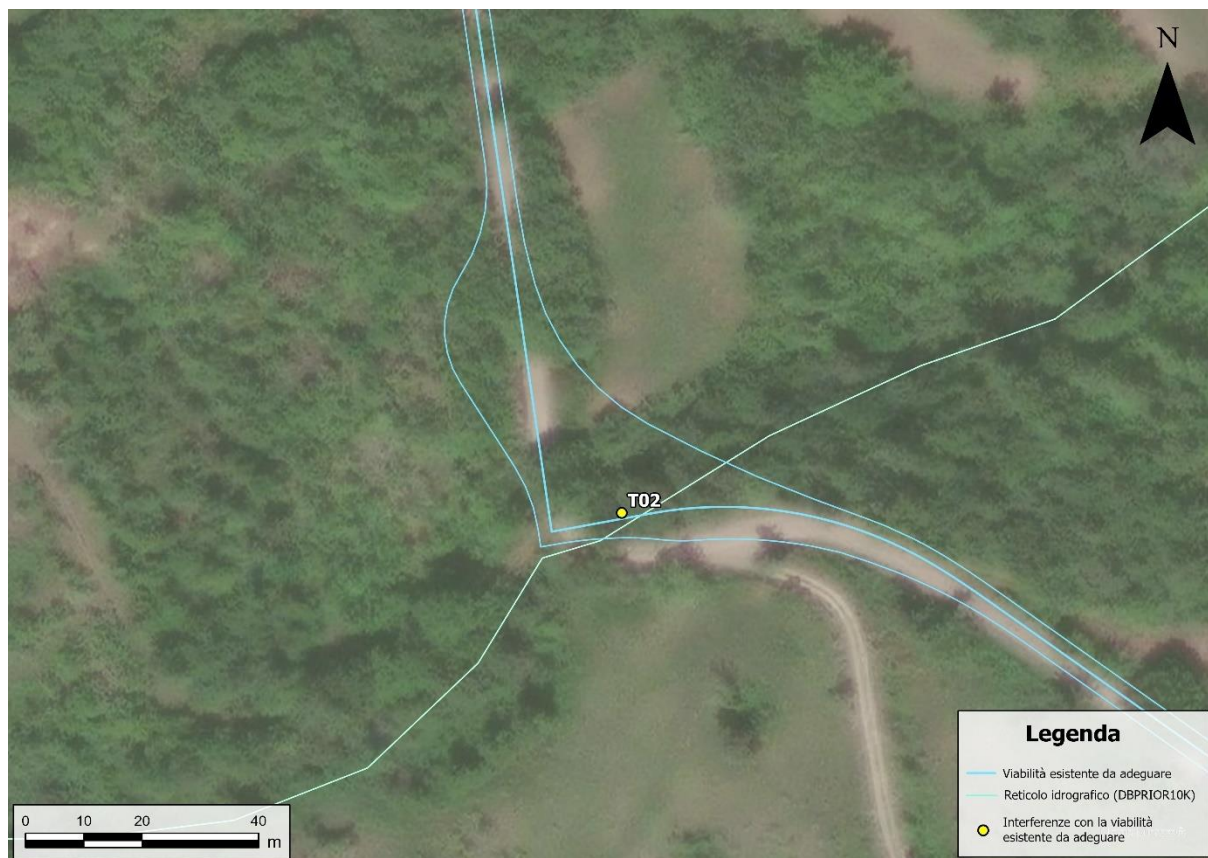
Figura 7.5: Interferenza T02, tra la viabilità di accesso (in azzurro) alle torri di progetto e il reticolo idrografico (DBPRIOR10K) (in celeste).
