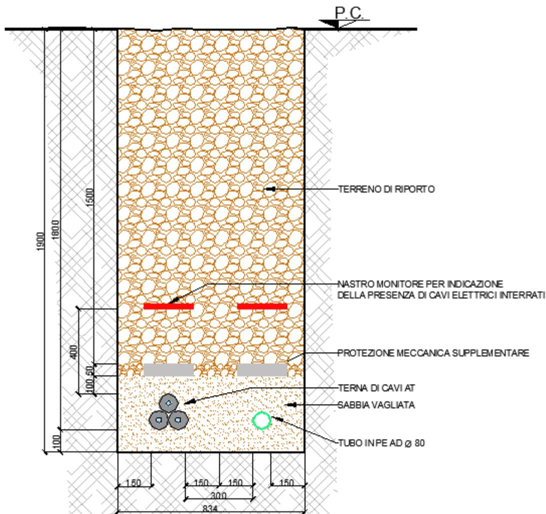
Figura 4.1: Sezione scavi tipo posa cavidotti AT
