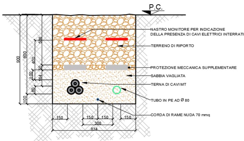
Figura 4.1: Sezione scavi tipo posa cavidotti MT
