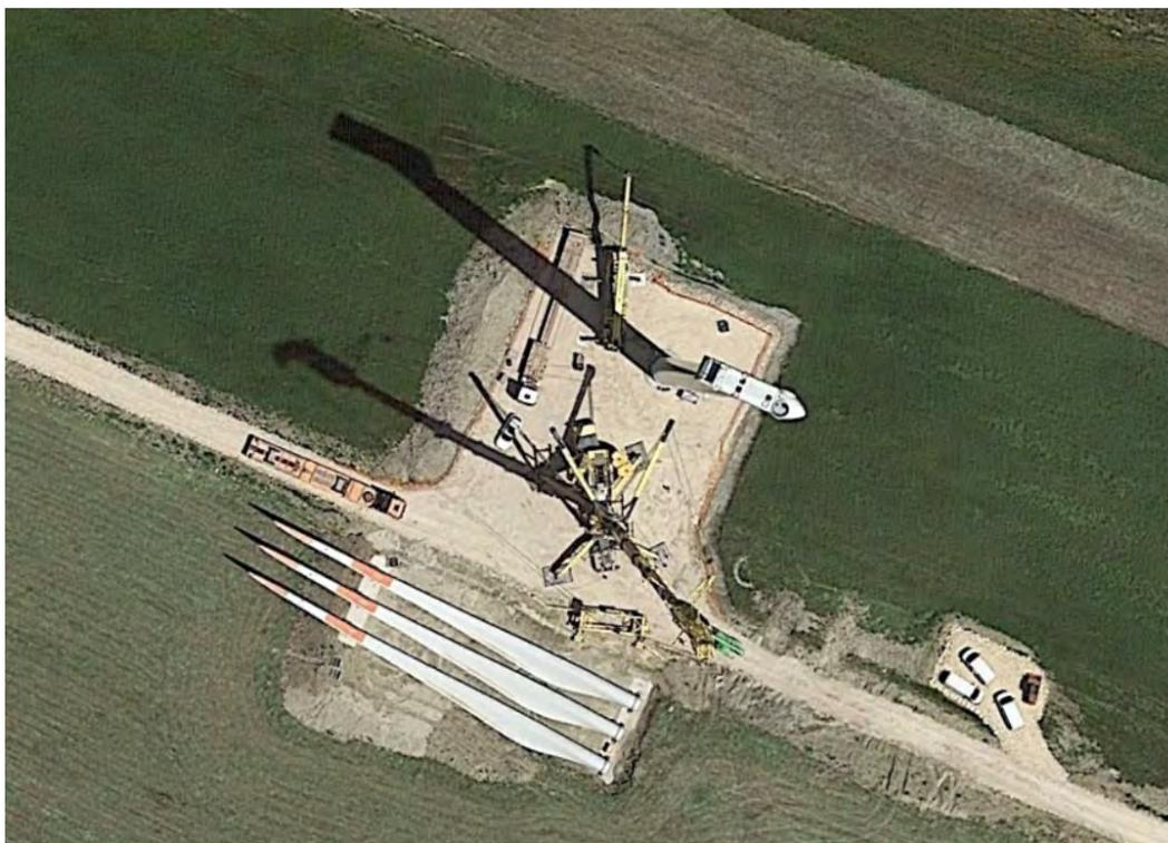
*Figura 2.9: esempio di piazzola in fase di costruzione*
