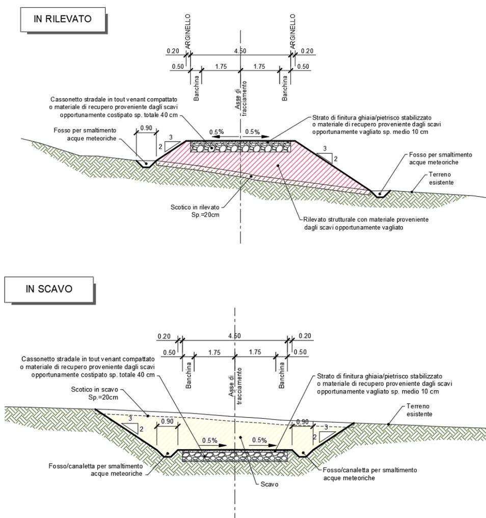
Figura 4.3: Sezione tipo piste di accesso
