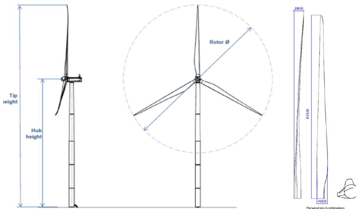
Altezza massima=200m; altezza al rotore=114m; diametro del rotore=172m; lunghezza pale≈84 m
