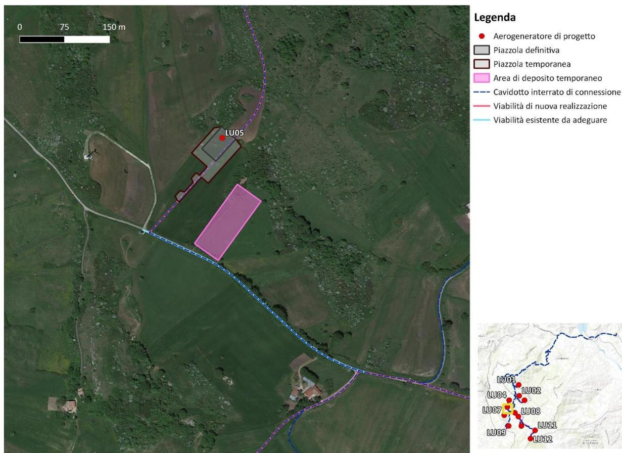
Figura 4.5: Localizzazione dell'area di deposito temporaneo per la fase di cantiere all'interno dell'impianto.
