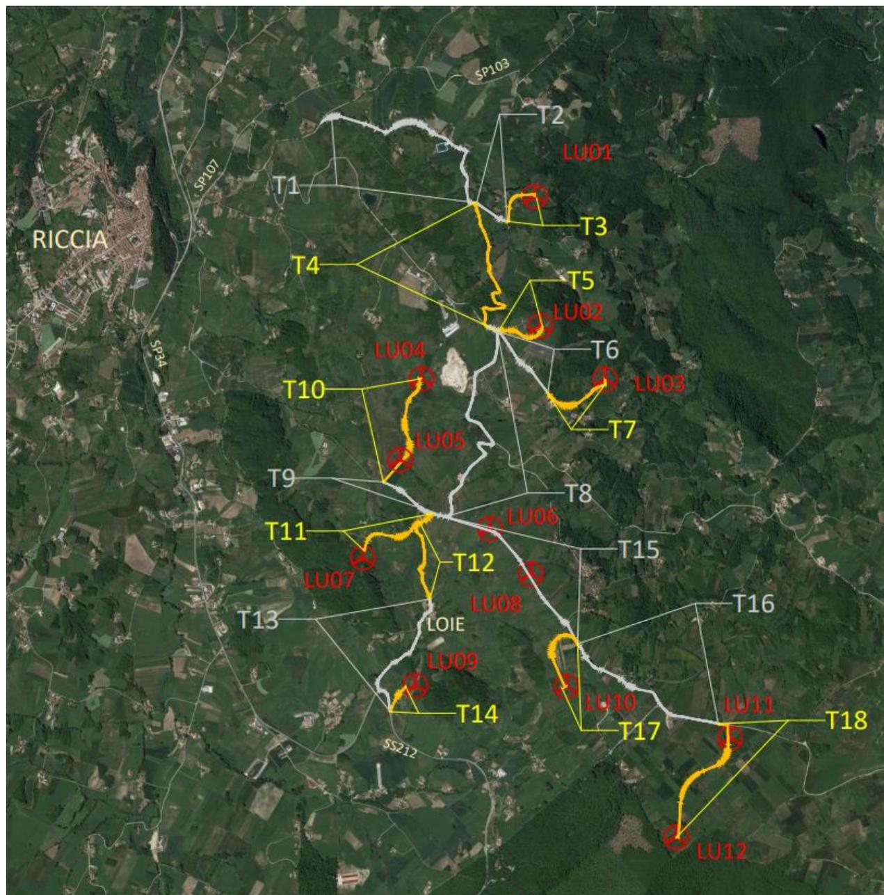
Figura 4.2: viabilità interna al sito (arancio=strade sterrate/piste; grigio=strade asfaltate) N.B. i tratti T4 e T12 in sterrato verranno interessati solo dalla posa del cavidotto.
