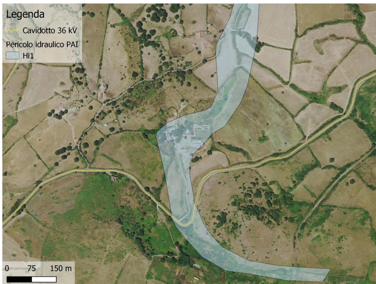
Figura 2.2: Limitato tratto di cavidotto interrato a 36 kV sovrappontesi con aree e pericolosità idraulica moderata – Hi1
