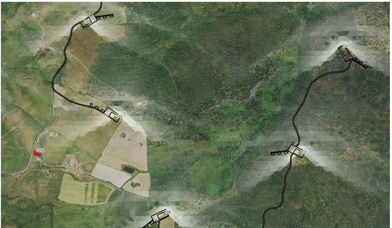
Figura 6.1 – Posizionamento del ricettore F054 rispetto agli aerogeneratori T02, T06, T07 e T16, all’origine di un potenziale ombreggiamento intermittente sul fabbricato. In evidenza, con sfumatura bianca, le isolinee d’ombra
